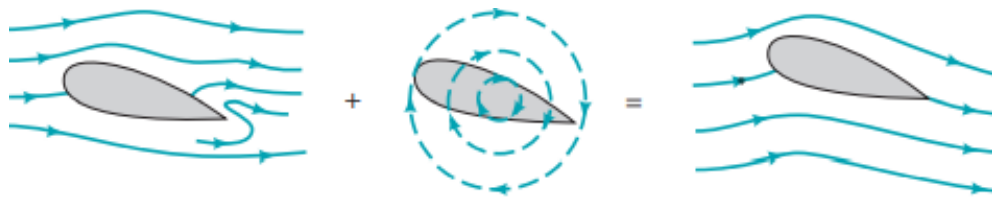
Figura 1.8. Superposición de un flujo no viscoso más un flujo en circulación para obtener la sustentación [23].
